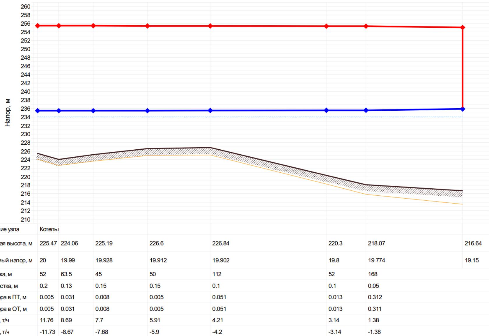
Рисунок 7 - Пьезометрический график тепловой сети от котельной №2 (р.п. им. В.И. Ленина, ул. Молодежная, 3а) до определяющего потребителя – жилой дом (р.п. им. В.И. Ленина, ул. Молодежная, 9)
