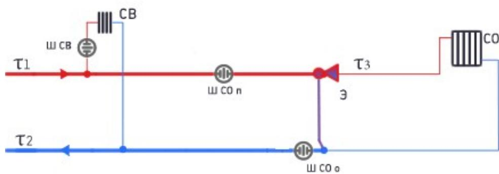
Рисунок 2 – Схема подключения потребителей к двухтрубной тепловой сети (при наличии внутридомовой системы отопление), в качестве регулятора температуры используется элеватор (СО – система отопления, Э – элеватор, СВ – система вентиляции)
