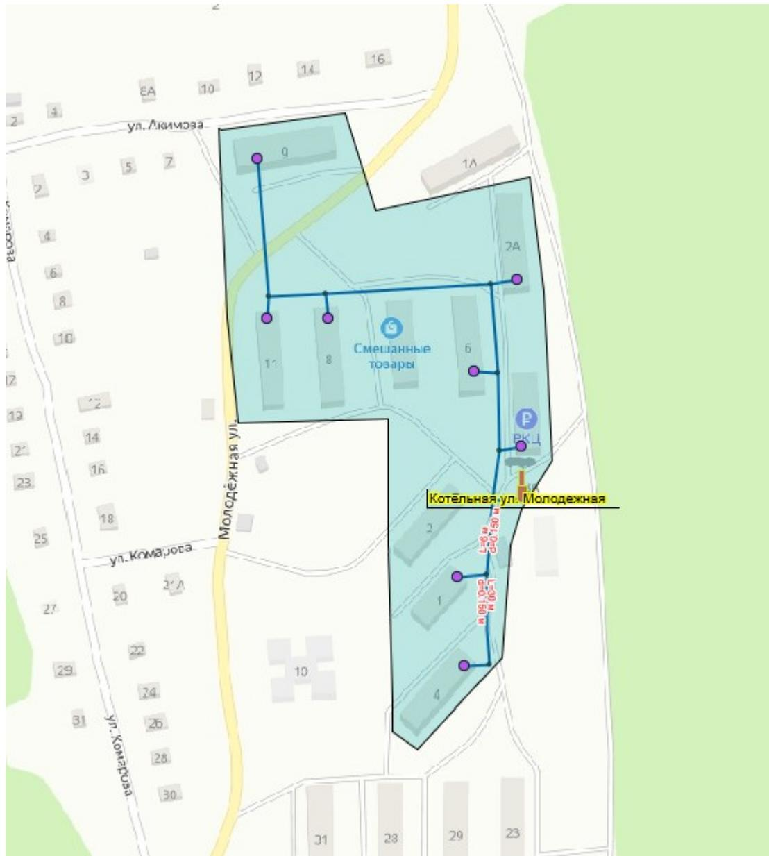
Рисунок 5 – Зона действия источников теплоснабжения р.п. им. В.И. Ленина
