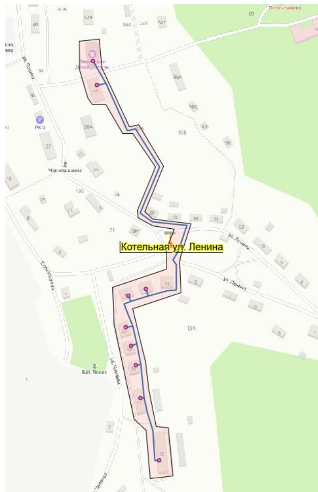
Рисунок 4 – Зона действия источников теплоснабжения р.п. им. В.И. Ленина
