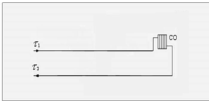
Рисунок 1 - Схема подключения потребителей к двухтрубной тепловой сети (при наличии внутридомовой системы отопление), зависимое присоединение, без смешения
