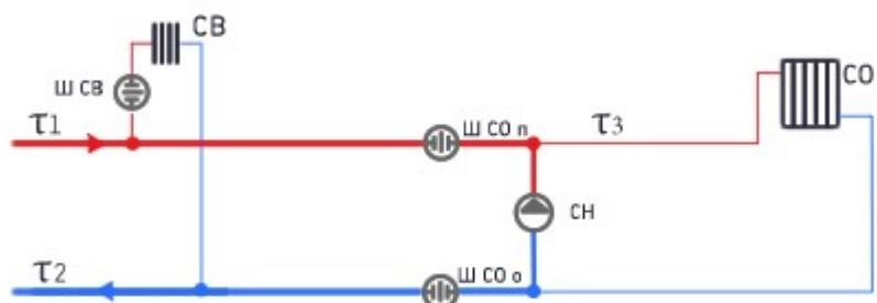
Рисунок 3 – Схема подключения потребителей к двухтрубной тепловой сети (при наличии внутридомовой системы отопление), СО – система отопления, СН – насос системы отопления, СВ – система вентиляции
